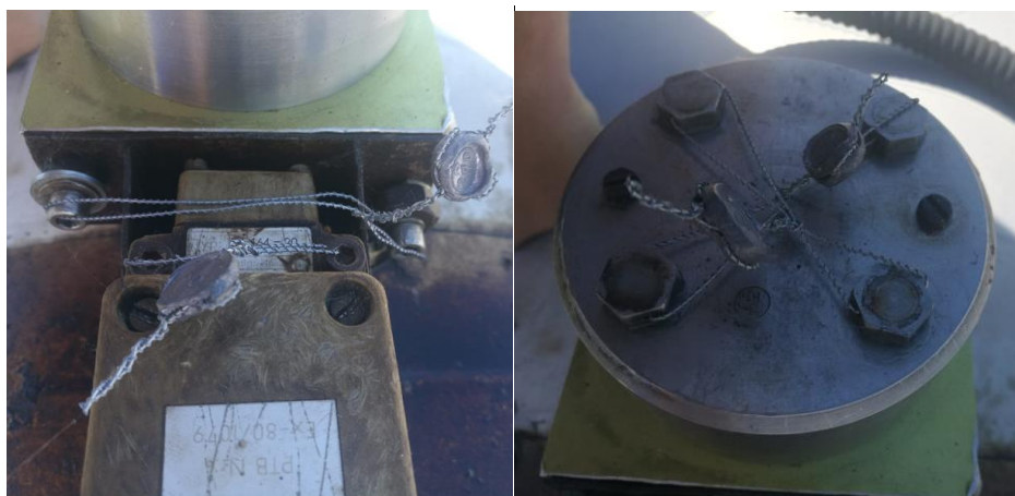
Рисунок 2 – Схема пломбировки детекторов
