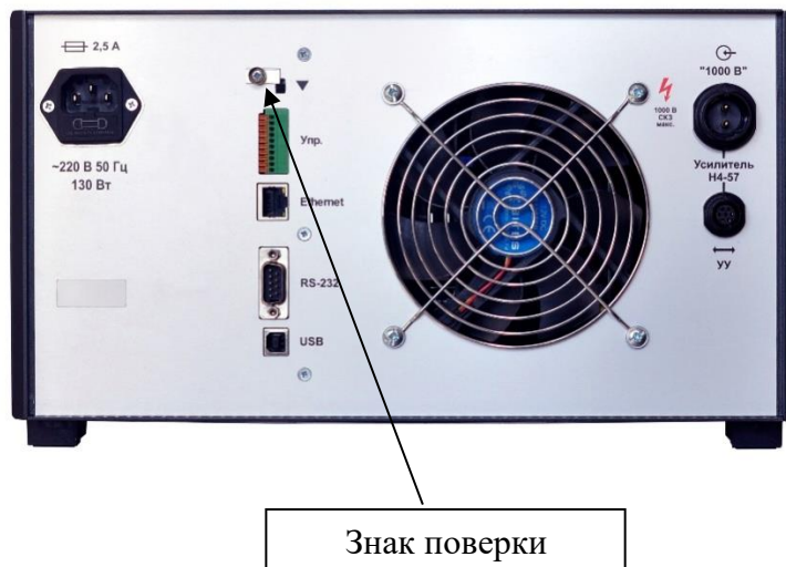
Рисунок 3 - Место нанесения знака поверки, предотвращающего доступ к поправочным коэффициентам.
