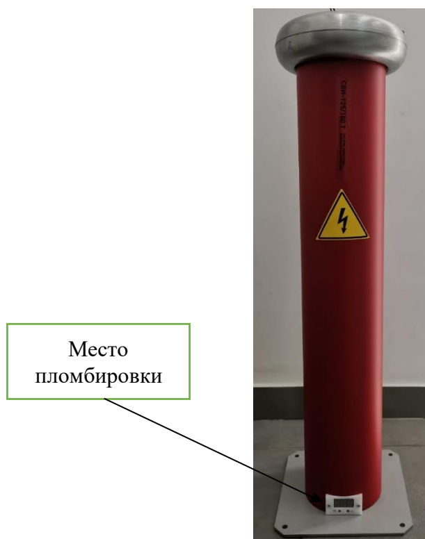
Рисунок 2 - Общий вид и обозначение мест пломбировки от несанкционированного доступа модификации СВИ-125/180
