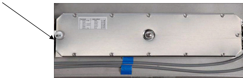
Рисунок 4 – Место пломбирования АЦП ГПУ
