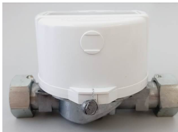
Рисунок 3 - Пломбировка навесной пломбой с оттиском знака поверки.
