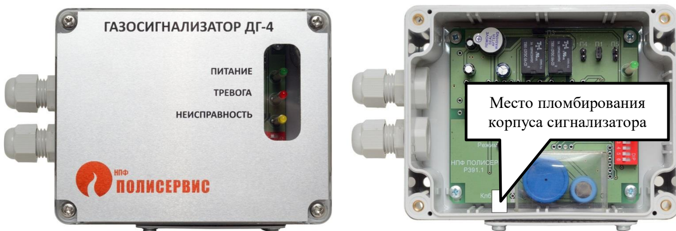
Рисунок 3- Общий вид сигнализаторов модели ДГ-4 и схема пломбирования корпуса сигнализатора от несанкционированного доступа (пломба наносится на стык между платой и корпусом методом наклейки)
