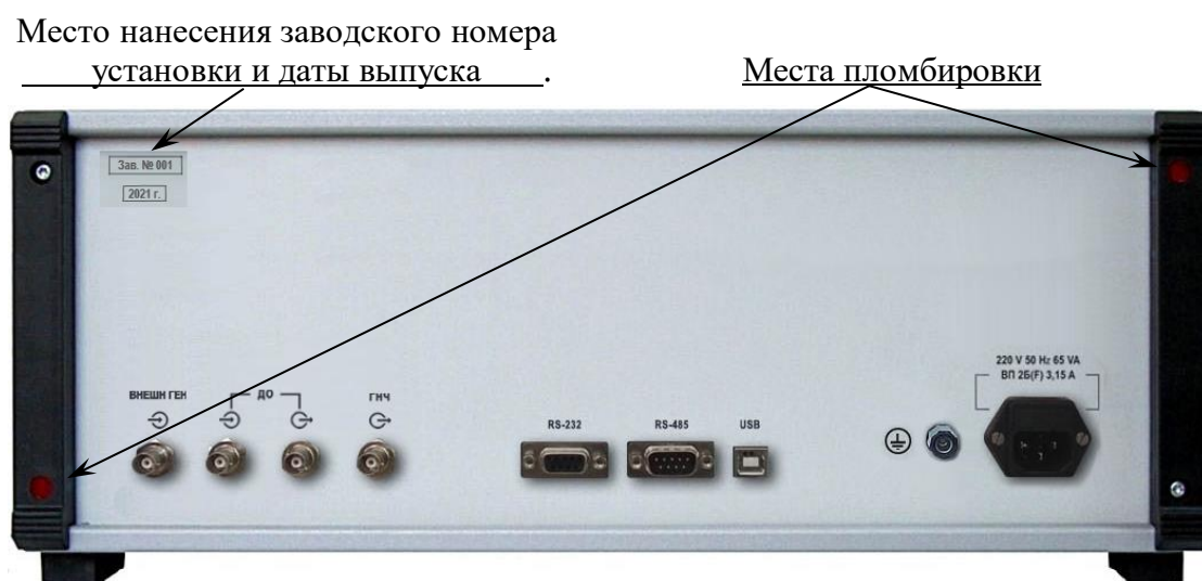
Рисунок 2 - Задняя панель установки, место нанесения заводского номера и даты выпуска прибора, места пломбировки
