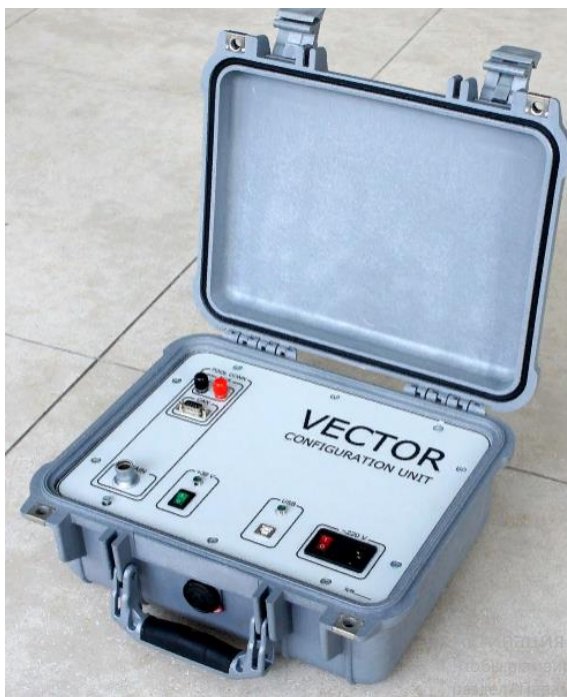
Рисунок 2 – Внешний вид наземной части модулей инклинометрии и ГК LWD 48.04.00.00.000 забойной телеметрической системы с гидравлическим каналом связи Вектор
