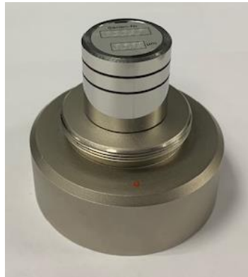
Рисунок 2 – Мера для калибровки увеличения к прибору FMS 8200
