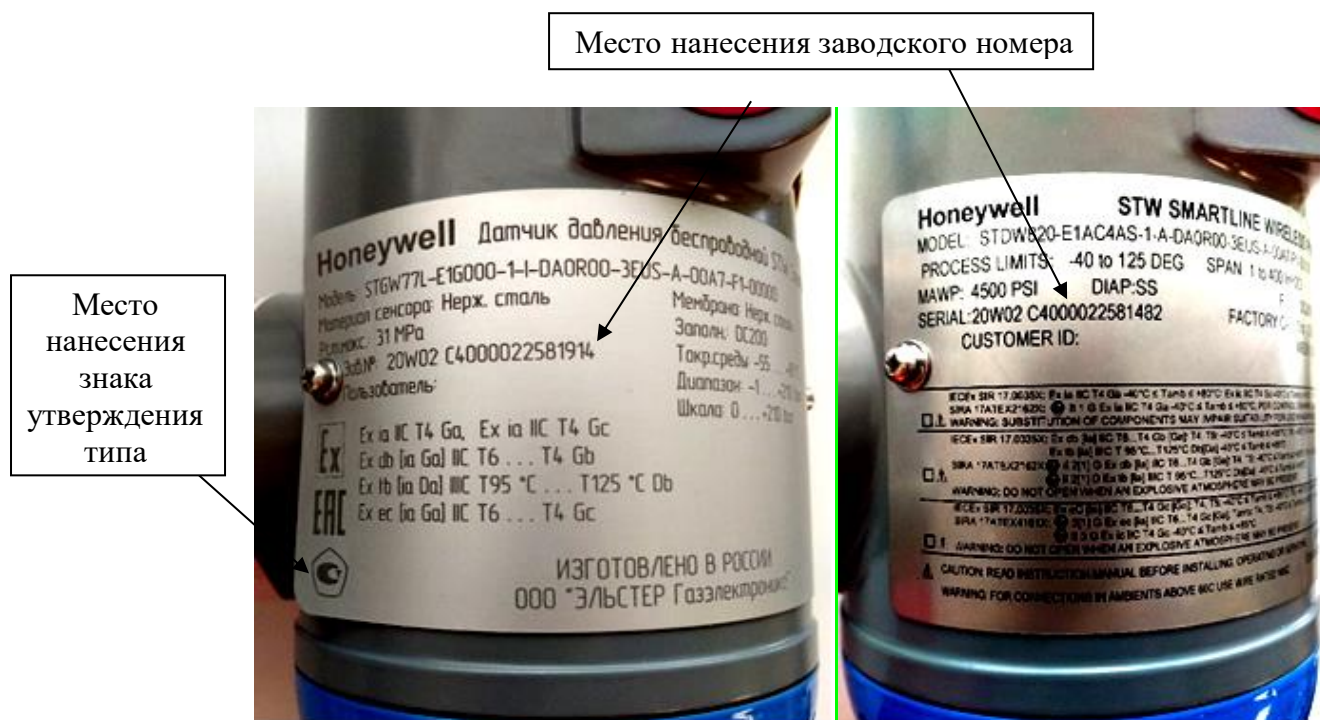
Рисунок 4 – Место нанесения заводского номера и знака утверждения типа датчиков давления беспроводных STW SmartLine Wireless
