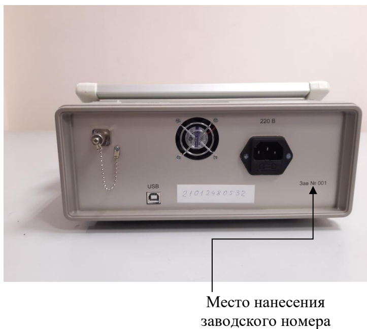
Рисунок 2 – Обозначение места нанесения заводского номера
