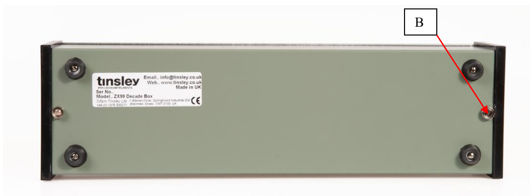
Рисунок 9 – Общий вид задней панели мер АКИП-7518 и схема пломбировки от несанкционированного доступа
