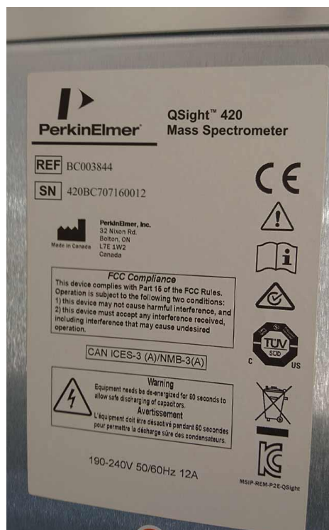
Рисунок 2- Информационная табличка (шильд) детектора
