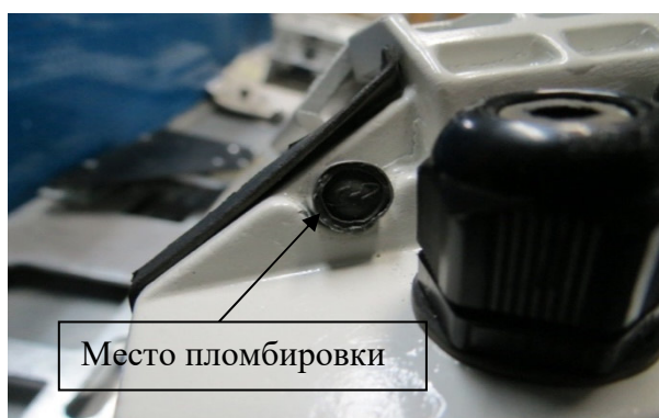
Рисунок 4 – Схема пломбировки видео модуля
