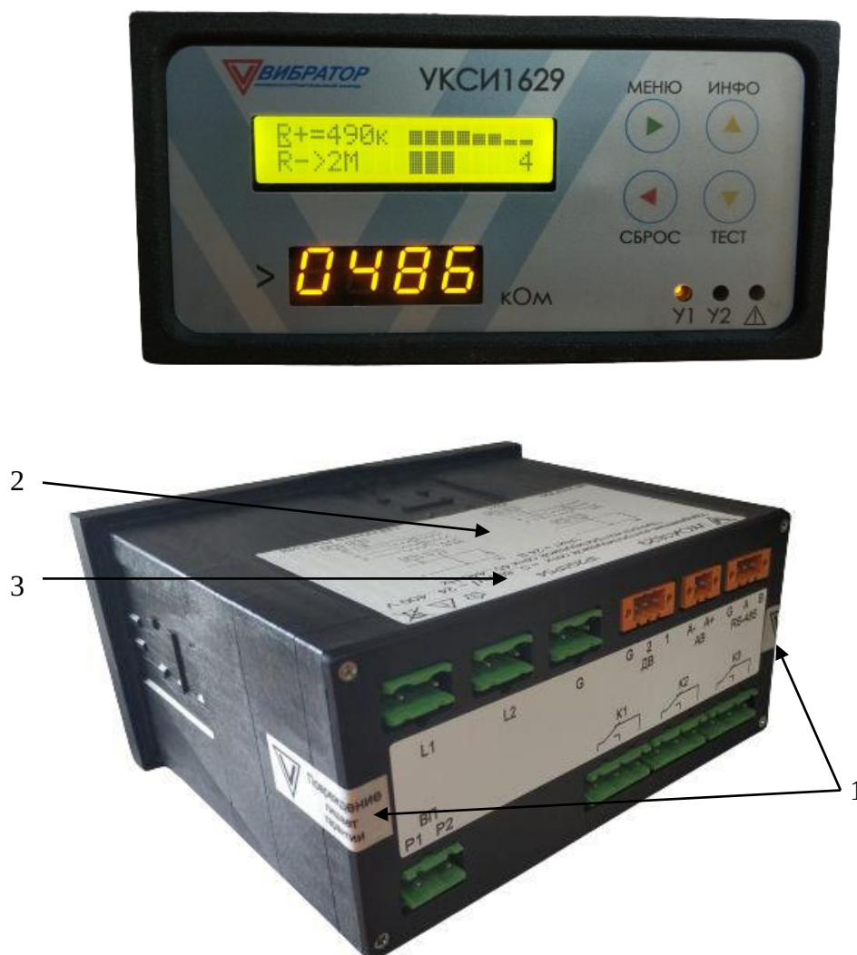
Рисунок 1 – Общий вид УКСИ1629 с указанием мест нанесения знака утверждения типа, знака поверки и пломбировки
