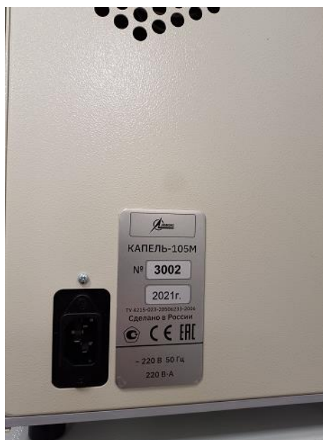
Рисунок 2 - Система капиллярного электрофореза Капель-105М, вид части задней панели с заводским шильдом
