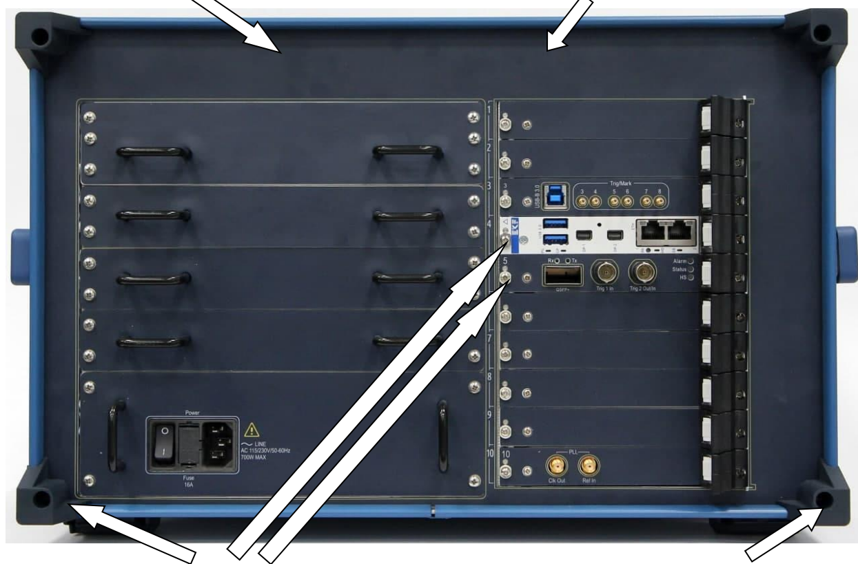
Рисунок 3 – Схема пломбировки анализатора
