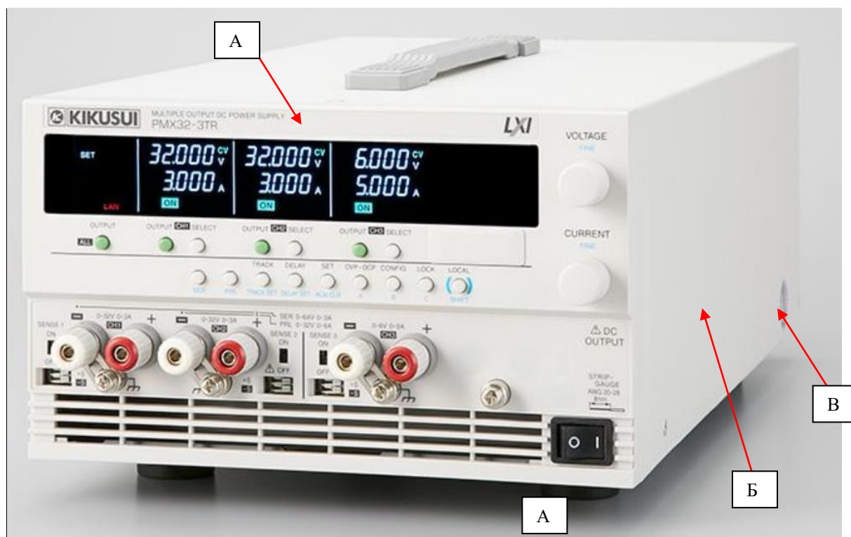
Рисунок 4 – Общий вид источников PMX32-3TR, места нанесения знака утверждения типа (А), знака поверки (Б) и пломбировки (В)
