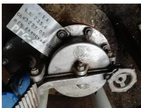
Рисунок 9 – Фотография горловины, замерного люка и заводского номера резервуара стального горизонтального цилиндрического РГС, модификации РГС-5 зав.№ 1А
