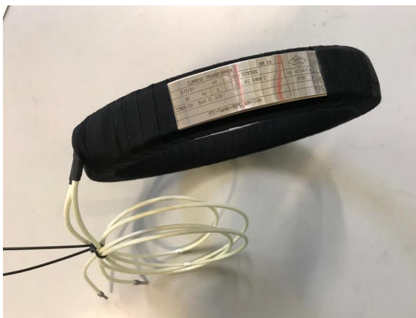
Рисунок 1 – Общий вид трансформаторов тока IBR 0.5, зав №№ 31202559, 31202560, 31202561, 31202562, 31202563, 31202564, 31202565.
