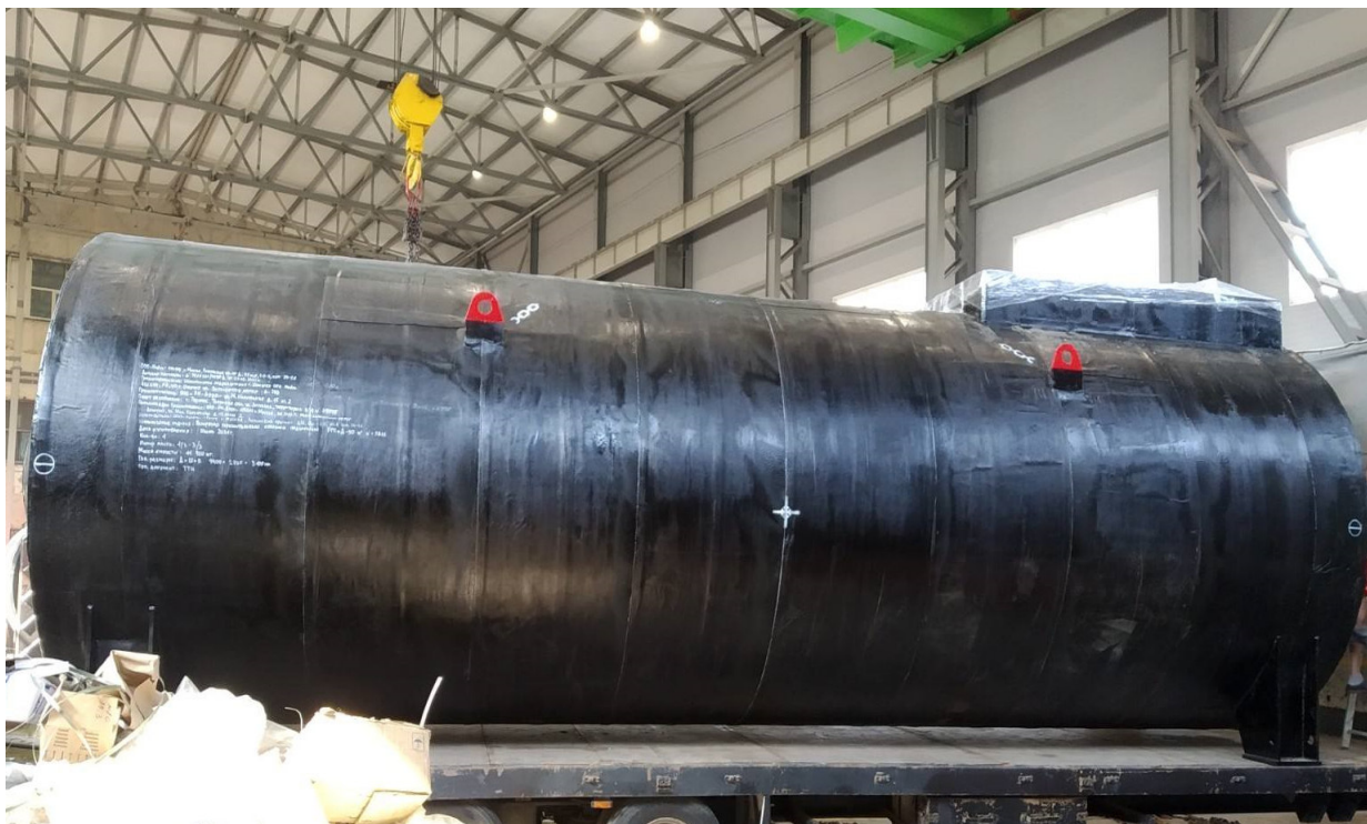
Рисунок 1 – Общий вид резервуаров РГСпД
