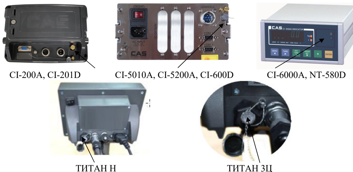
Рисунок - 4 Схема пломбировки от несанкционированного доступа и обозначение места для нанесения оттиска клейма на пломбу
