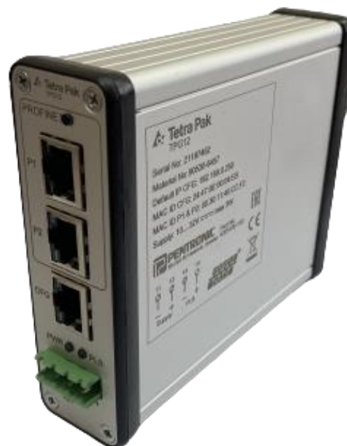
Рисунок 2 – Общий вид сетевого шлюза TGP12 (PLG1242)
