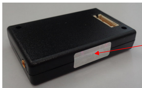
Рисунок 3 - Место пломбировки от несанкционированного доступа (вариант пломбировки № 2)
