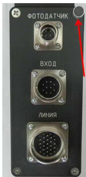
Рисунок 5 – Схема пломбировки от несанкционированного доступа ФЭБ-7М с линейкой фотодиодов
