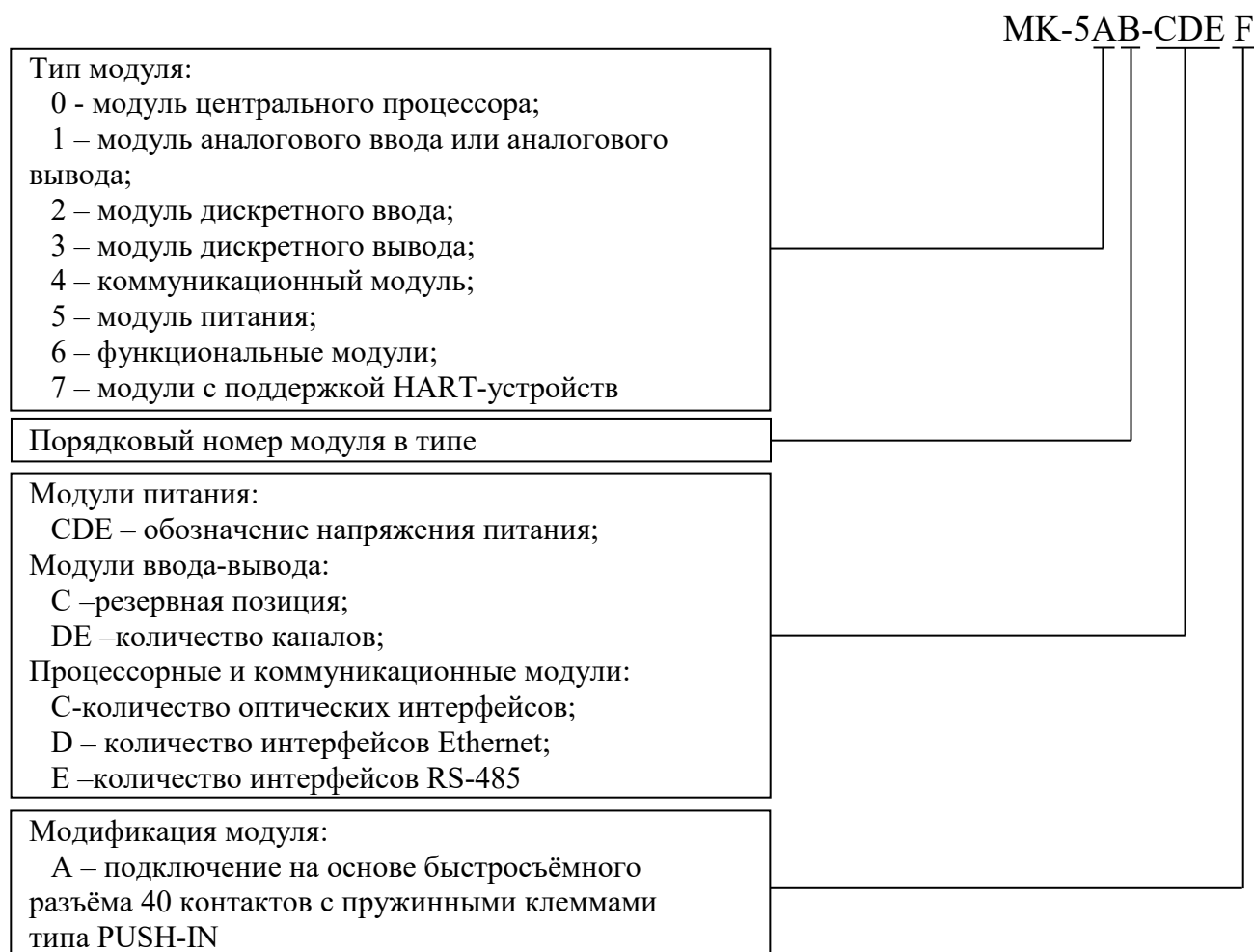
Рисунок 1 – Расшифровка условного обозначения модулей изделия.
