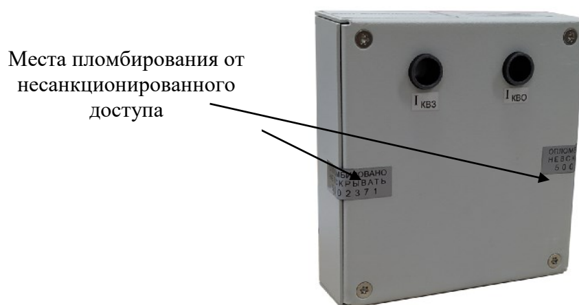
Рисунок 5 - Места пломбирования от несанкционированного доступа датчика напряжения ДН-3П
