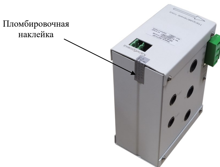
Рисунок 7 - Место пломбирования от несанкционированного доступа модуля МДТН-КР
