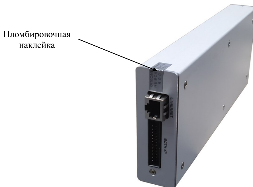
Рисунок 6 - Место пломбирования от несанкционированного доступа модуля НЭП-512С
