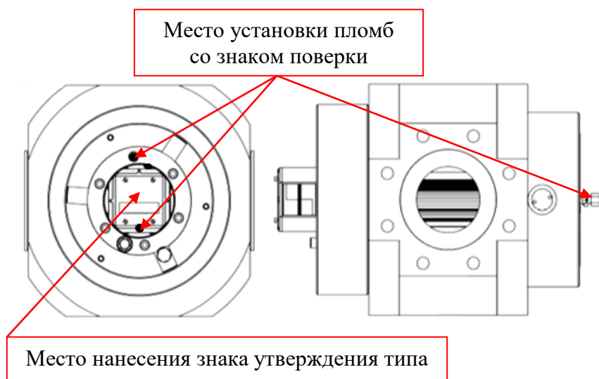
Рисунок 6 – Схема установки пломб со знаком поверки и места нанесения знака утверждения типа на счетчики исполнения Gray до 10,0 МПа
