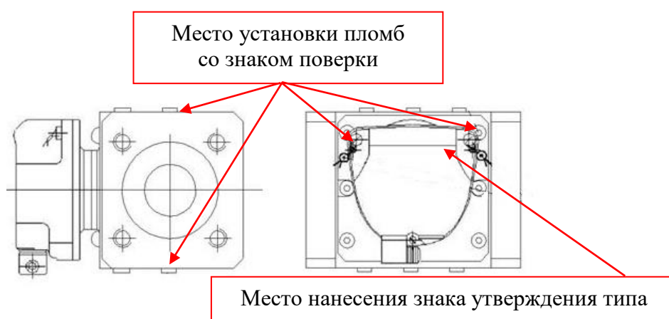
Рисунок 3 – Схема установки пломб со знаком поверки и места нанесения знака утверждения типа на счетчики базового исполнения DN25, DN40
