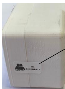
Рисунок 2 – Схема пломбировки от несанкционированного доступа
