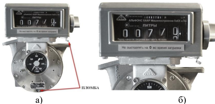
Рисунок 1 – Счетчик жидкости лопастной МКА а) Общий вид и схема пломбировки б) Механический сумматор
