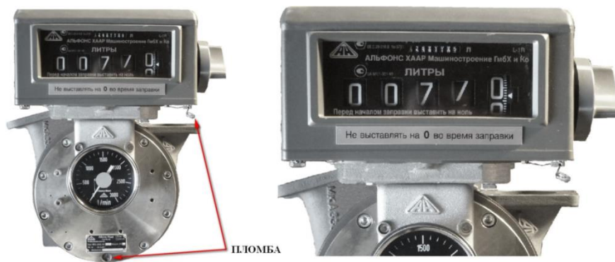
а) б) Рисунок 1 – Счетчик жидкости лопастной МКА а) Общий вид и схема пломбировки б) Механический сумматор
