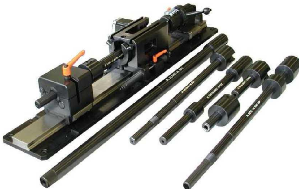
Рисунок 1 – Универсальный баллистический затвор UZ-2002 и измерительные баллистические стволы
