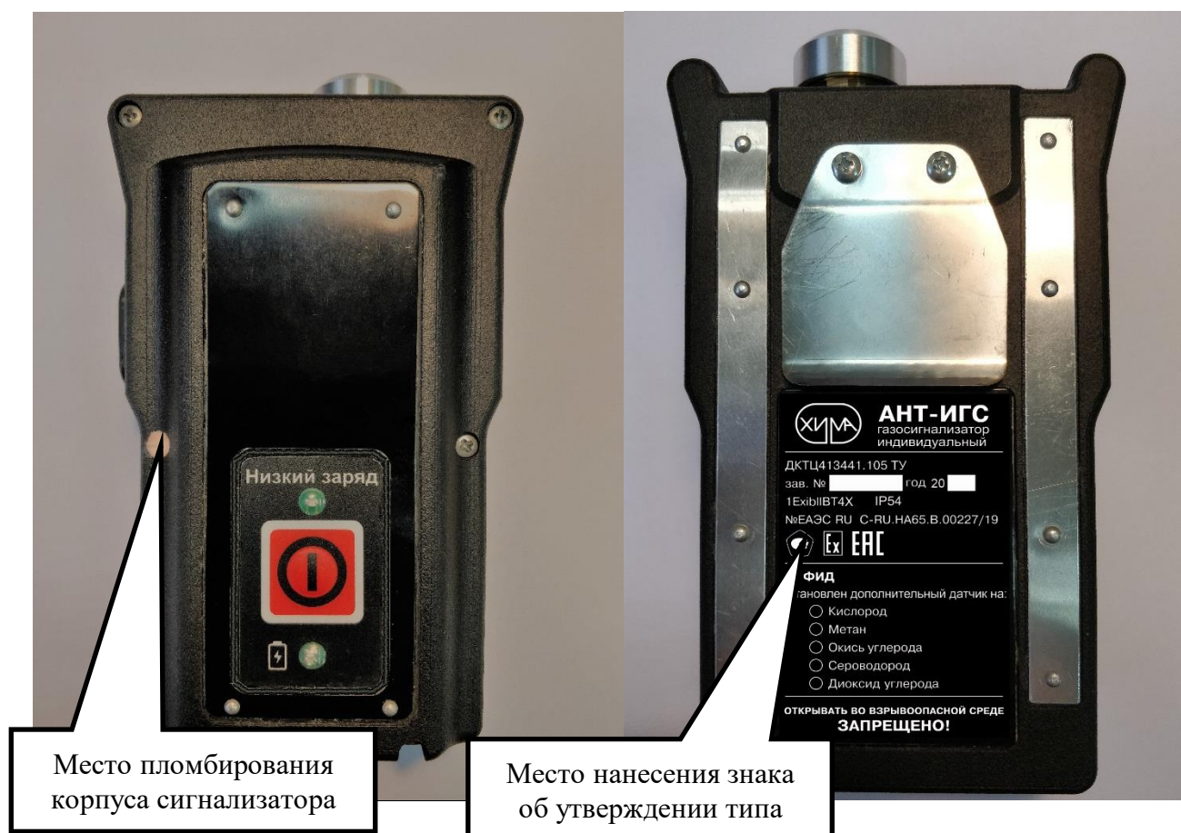
Рисунок 1 - Общий вид газосигнализаторов индивидуальных АНТ-ИГС, место пломбирования от несанкционированного доступа (пломбирование прибора производится мастикой, место нанесения пломбы указано стрелкой)
