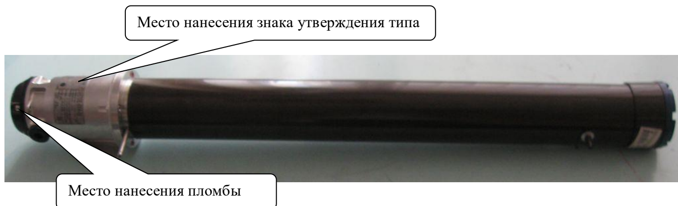
Рисунок 2 – Общий вид, схема пломбировки и место нанесения знака утверждения типа газоанализатора модификации GD10-PE0-XXXX-0YZ-00
