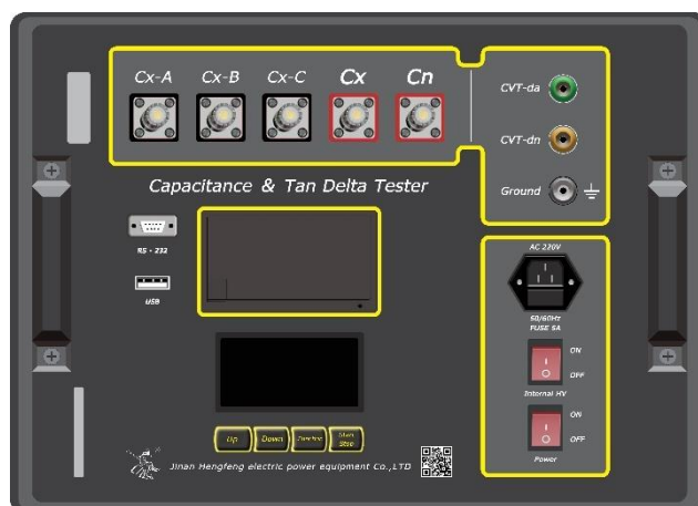
Рисунок 3 - Общий вид лицевой панели модификаций HFJS-8007G и HFJS-8207G
