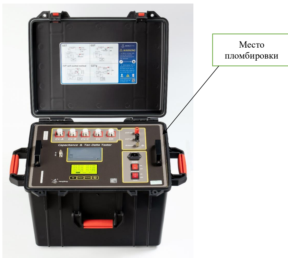
Рисунок 1 - Общий вид и обозначение мест пломбировки от несанкционированного доступа
