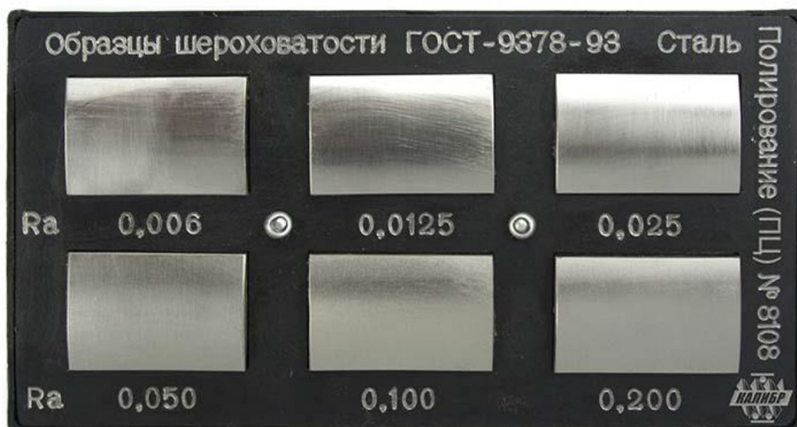
Рисунок 2 – Общий вид образцов шероховатости в наборе из 6 штук в неразборной обойме
