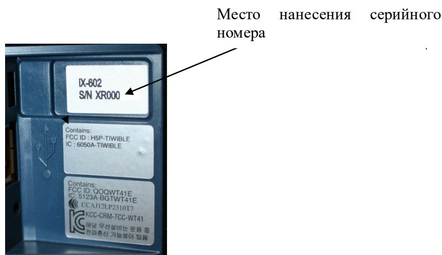
Рисунок 2 – Маркировка тахеометров электронных SOKKIA iX
