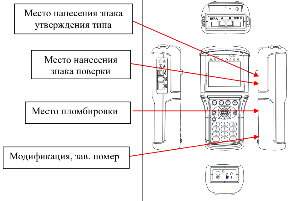
Рисунок 3 – Общий вид тестера-анализатора (модификация МАКС-ЕМК-Е)
