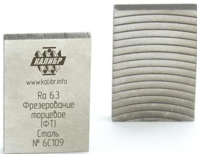
Рисунок 7 – Общий вид образцов шероховатости, поставляемых отдельными образцами
