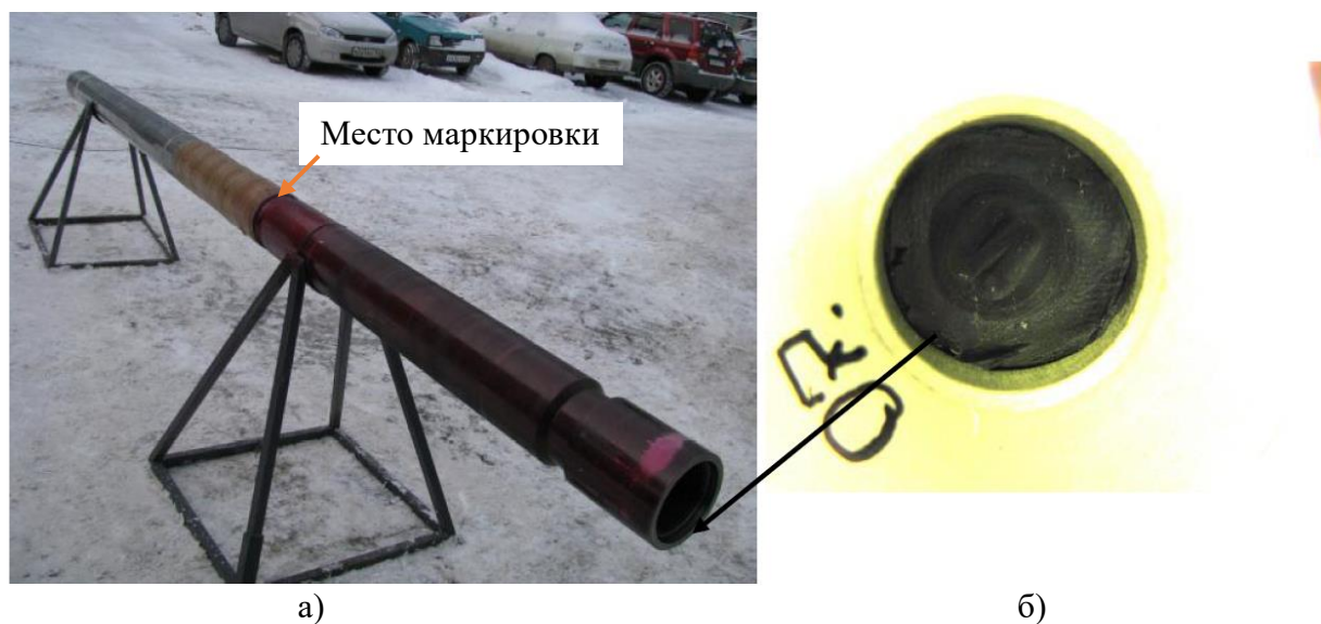
Рисунок 1 – Системы забойные инклинометрические ЗТК а) внешний вид; б) схема пломбировки оборудования скважинного системы ЗТК
