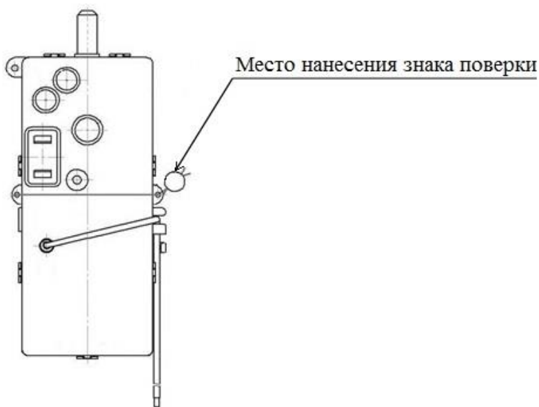
Рисунок 5 – Схема пломбировки от несанкционированного доступа, обозначение места нанесения знака поверки на счетчиках в корпусе «тип I»
