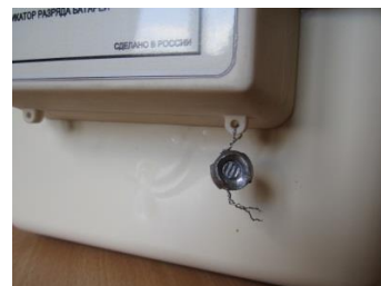
Рисунок 7 - Пломбирование крышки батарейного отсека ОМЕГА ЭК К
