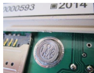
Рисунок 4 - Место пломбирования счетчика газа ОМЕГА ЭК К
