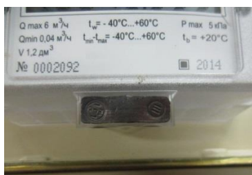
Рисунок 3 - Место пломбирования счетчика газа ОМЕГА ЭК
