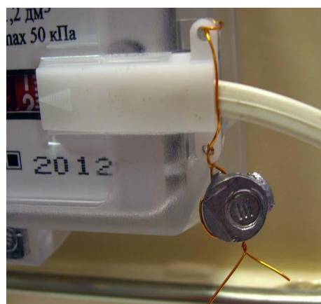
Рисунок 4 Схема пломбировки датчика импульсов
