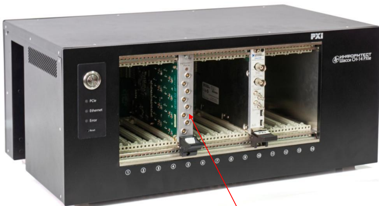
Рисунок 2 – Измеритель, установленный в шасси CH-14 PXIe
