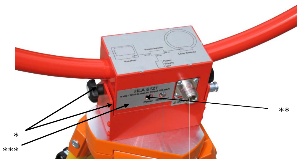
Рисунок 2 – Места пломбировки антенны
