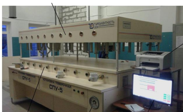
Рисунок 4 - СПУ-5-Х-3 Установка с тридцатью одновременно подключаемыми счетчиками
