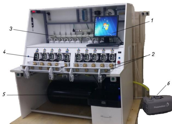
Рисунок 2 - СПУ-5-Х-1 Установка с десятью одновременно подключаемыми счетчиками
