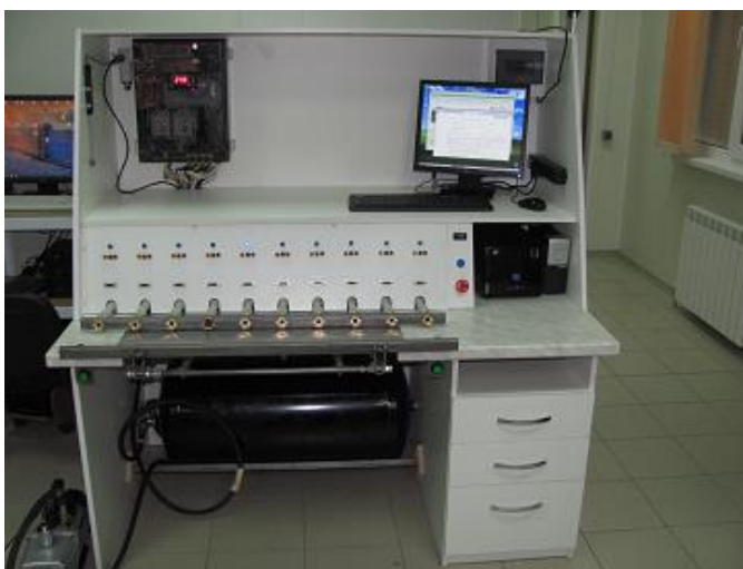
Рисунок 1 - СПУ-5-Х-1 Установка с десятью одновременно подключаемыми счетчиками
