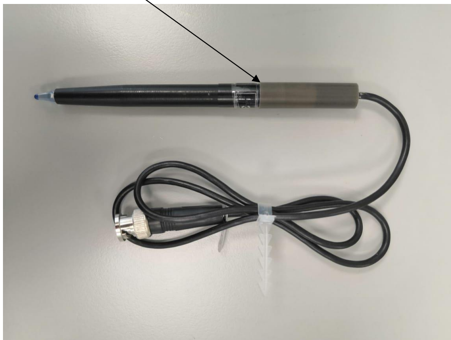
Рисунок 2 – Общий вид и схема пломбирования от несанкционированного доступа электродов ионоселективных комбинированных ЭК модификации ЭК-02
