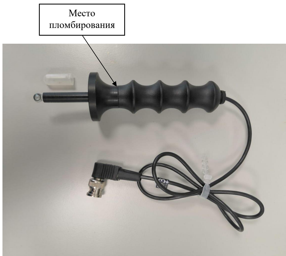
Рисунок 3 – Общий вид и схема пломбирования от несанкционированного доступа электродов ионоселективных комбинированных ЭК модификации ЭК-03
