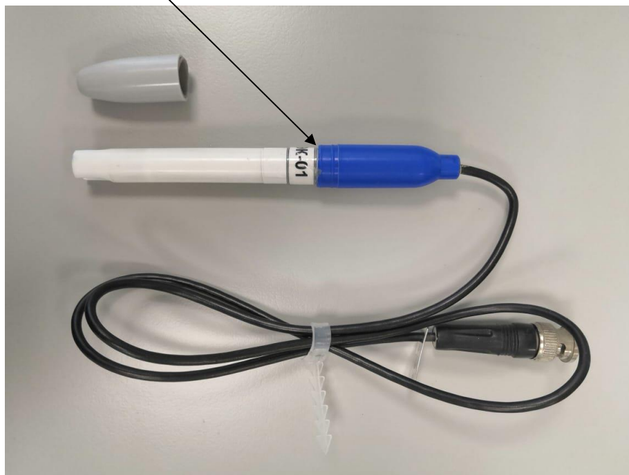
Рисунок 1 – Общий вид и схема пломбирования от несанкционированного доступа электродов ионоселективных комбинированных ЭК, модификации ЭК-01
