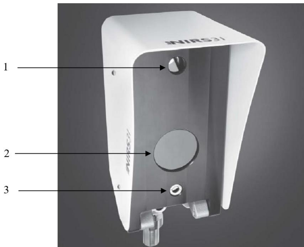
Рисунок 1 – Общий вид измерителей NIRS31-UMB 1 – приемник, 2 – излучатель, 3 - пирометр
