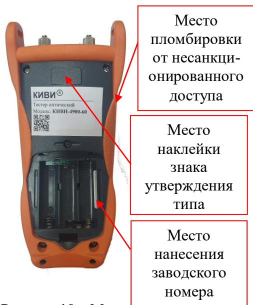
Рисунок 10 – Место нанесения заводского номера, место пломбировки от несанкционированного доступа, место наклейки знака утверждения типа источников оптического излучения КИВИ-420У, КИВИ-421У, измерителей оптической мощности КИВИ-430У, КИВИ-451У, аттенуаторов оптических КИВИ-4900-Z0
