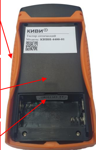
Рисунок 12 – Место нанесения заводского номера, место пломбировки от несанкционированного доступа, место наклейки знака утверждения типа тестеров оптических КИВИ-440У-0Z
