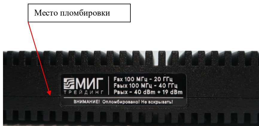
Рисунок 3 – Место пломбирования модуля расширения частоты
