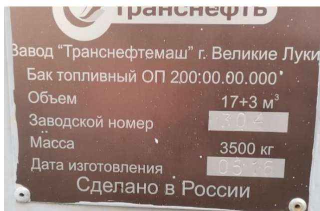
Рисунок 1 – Место и способ нанесения заводских номеров
