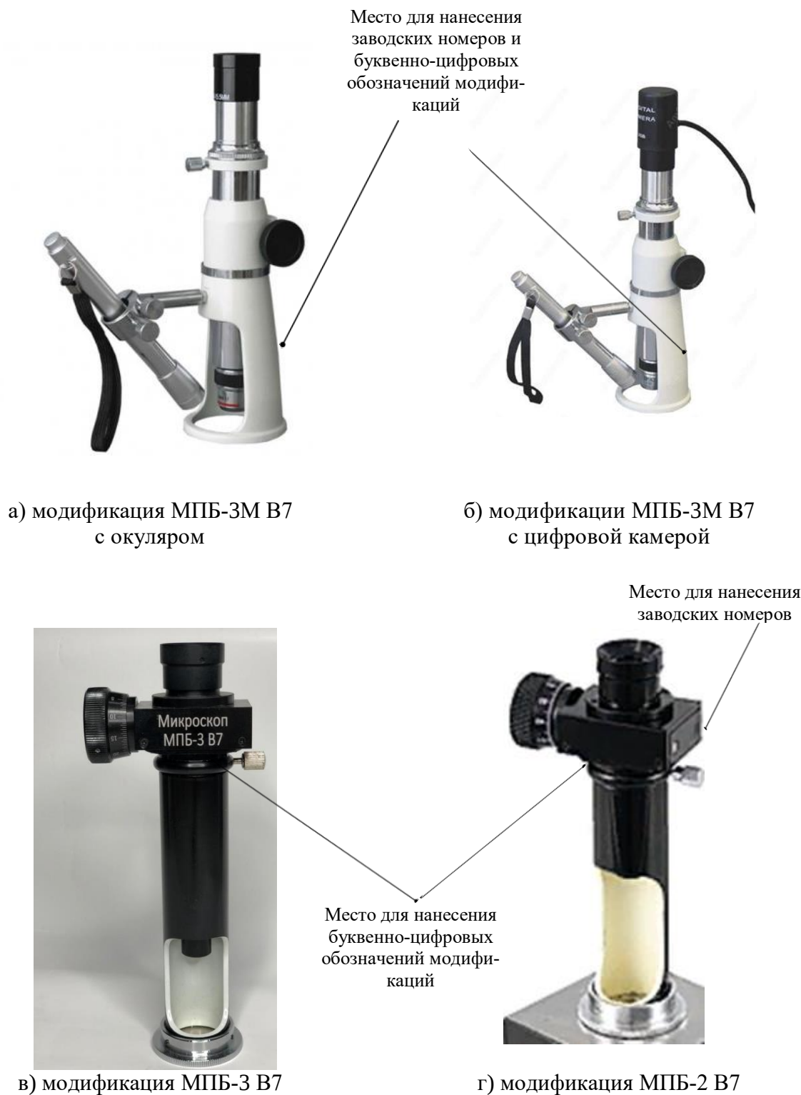
Рисунок 1 – Общий вид микроскопов отсчётных МПБ, обозначение места нанесения заводских номеров и буквенно-цифровых обозначений модификаций Пломбирование микроскопов от несанкционированного доступа не предусмотрено.
