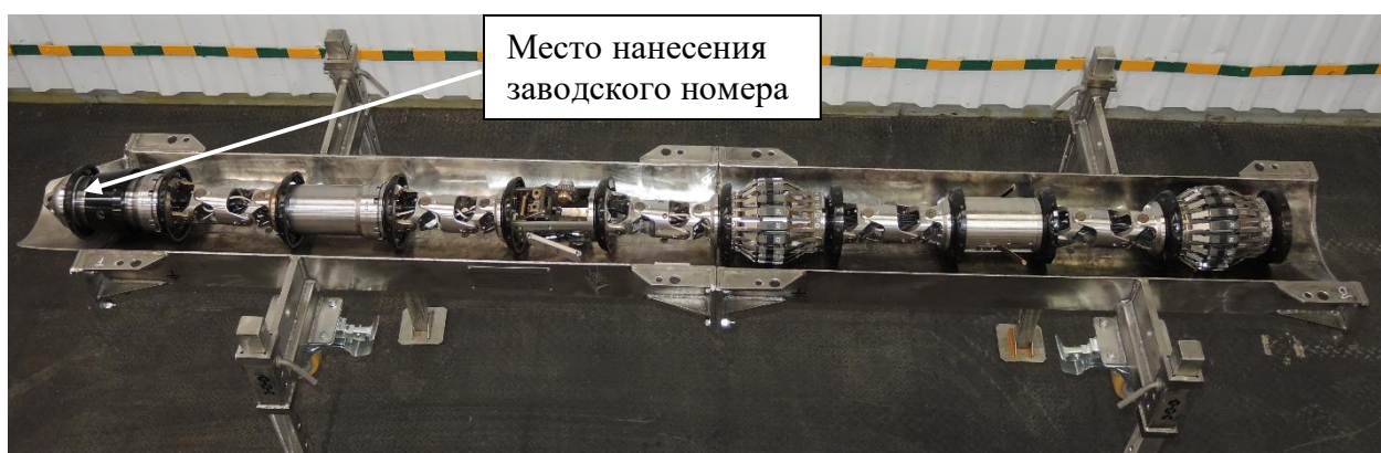
Рисунок 1 – Общий вид дефектоскопа внутритрубного магнитного 6-МСК.02-00.000-01
