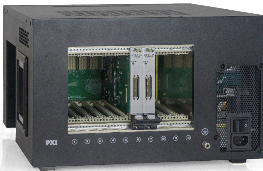
Рисунок 2 – Измерители сопротивления постоянному току MT24Л-PXIE и MT24Л-PXIE-01, установленные в моноблок CH-10 PXIe
