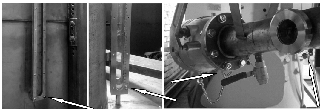
Рисунок 3 – Схема пломбировки от несанкционированного доступа, обозначение мест нанесения знака поверки установок поверочных средств измерений объема и массы УПМ-2000
