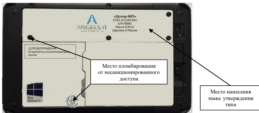
Рисунок 2 - Место нанесения знака утверждения типа и пломбирования комплекса модификации 01 «Дозор-МП»
