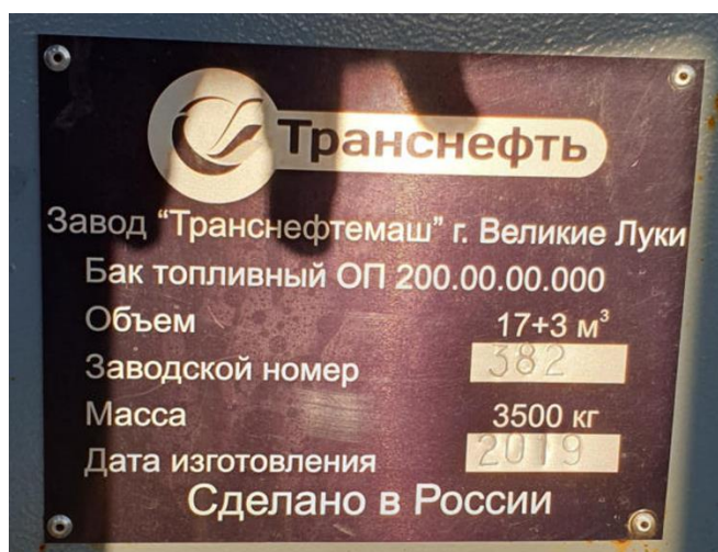
Рисунок 11 – Маркировочная табличка резервуара РГС-20 зав.№ 382
