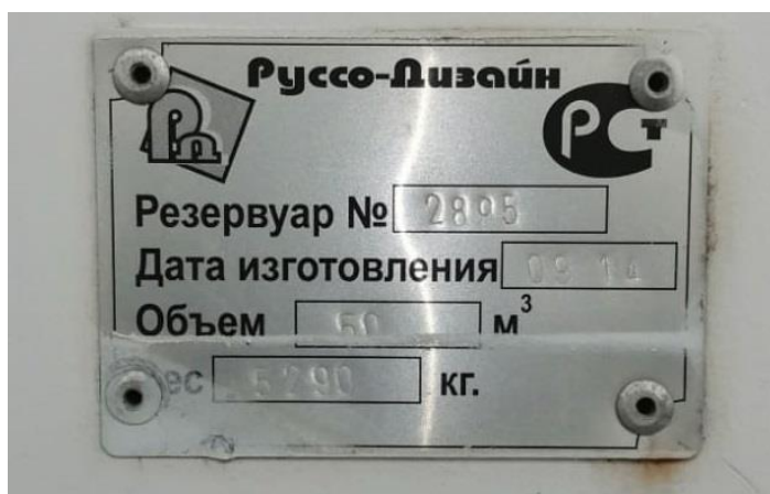
Рисунок 3 – Маркировочная табличка резервуара РГС-50 зав.№ 2895
