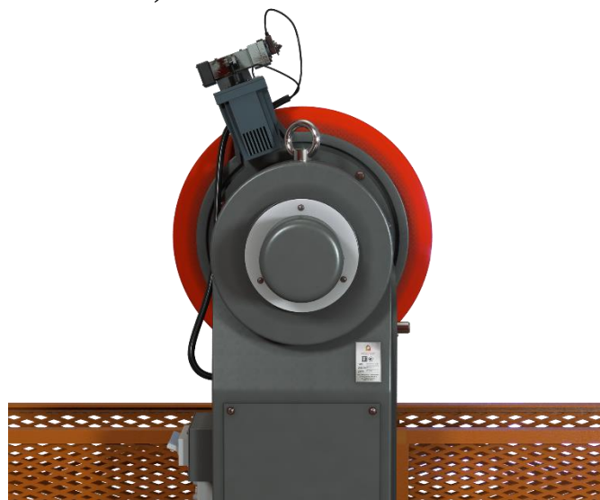
Рисунок 10 – Место нанесения идентификационных данных копров маятниковых КМ
