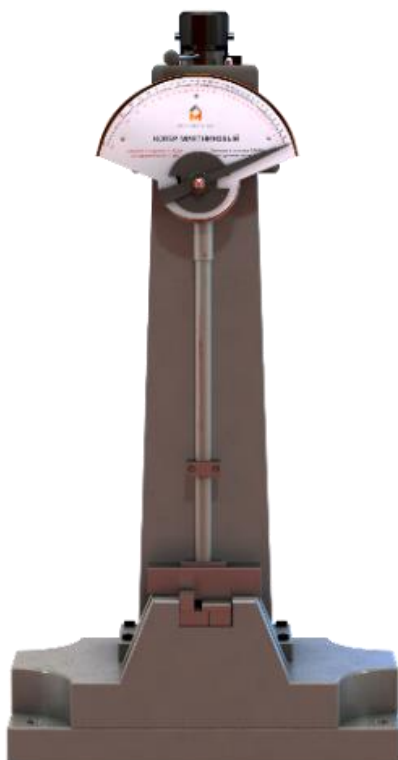
Рисунок 5 – Общий вид копра маятникового КМ-150(300/450)–Р–Ш
