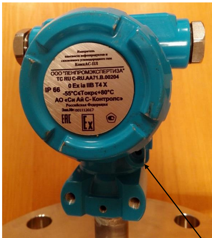
Рисунок 2 - Маркировка измерителя КомпАС-ПЛ и место пломбировки
