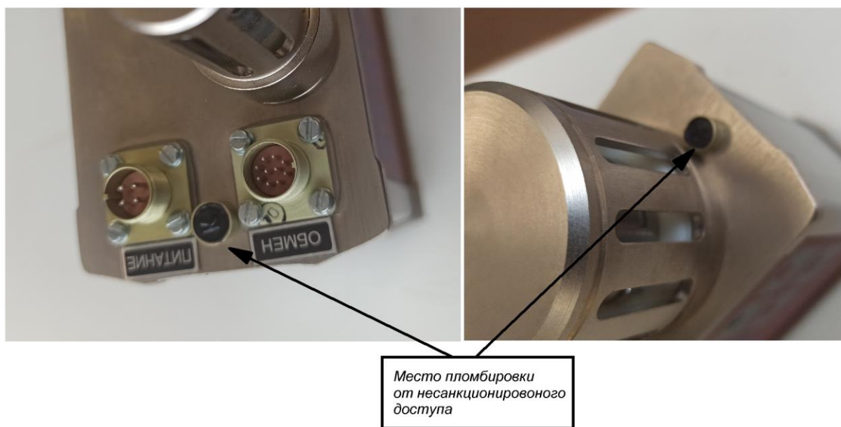
Рисунок 2 – Место пломбировки от несанкционированного доступа газосигнализатора автоматического ГСА/АИГ
