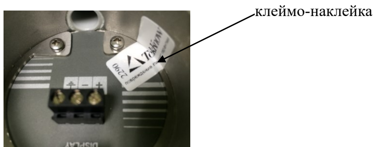
Рисунок 2 - Схема пломбировки от несанкционированного доступа
