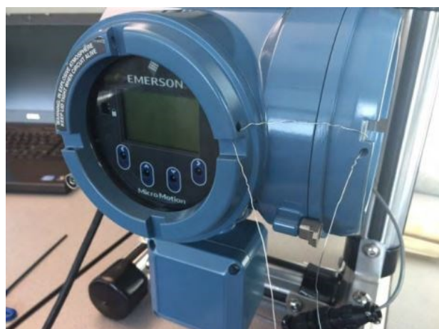
Рисунок 8. Вариант пломбирования корпуса электронного преобразователя модели 5700.
