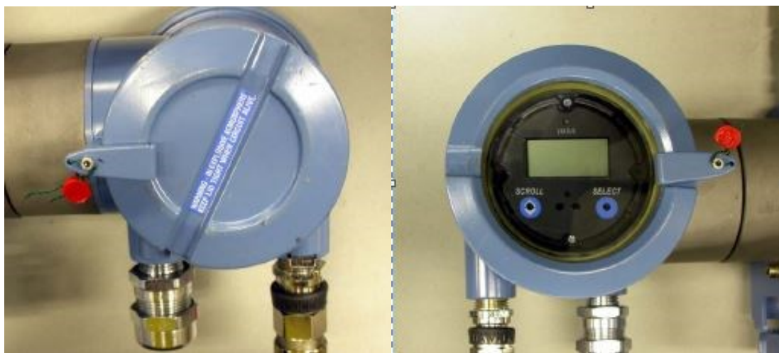
Рисунок 7. Вариант пломбирования корпуса электронных преобразователей моделей 1700, 2700.
