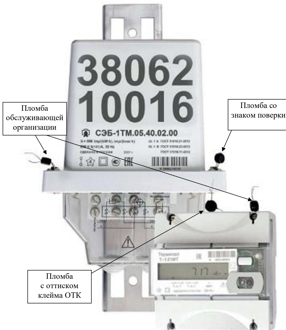
Рисунок 3 – Общий вид счетчика наружной установки, схема пломбировки от несанкционированного доступа, обозначение места нанесения знака поверки
