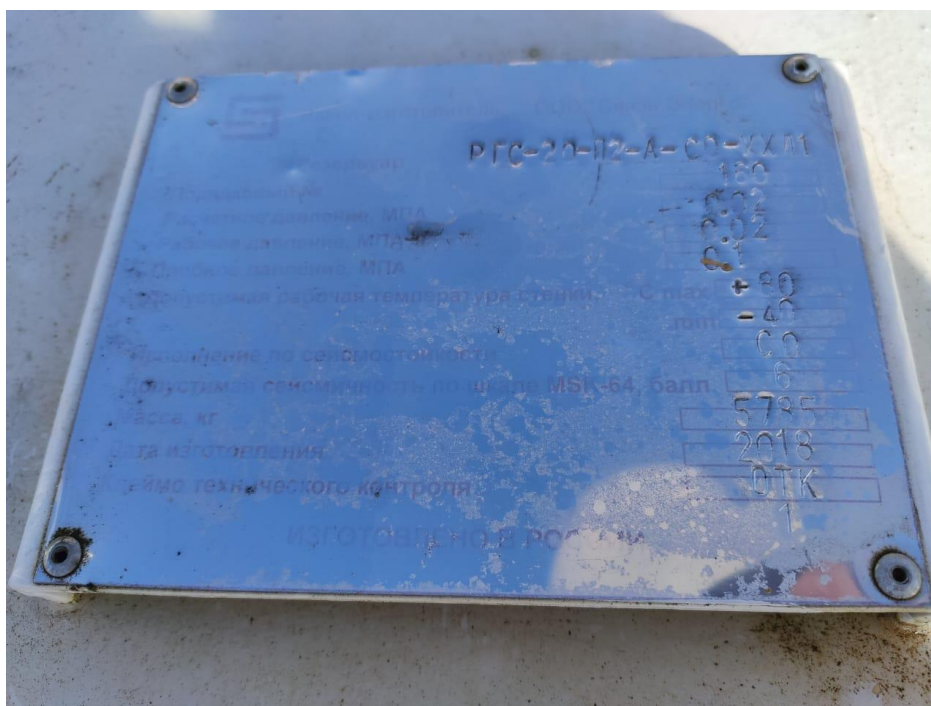
Рисунок 5 – Маркировочная табличка резервуара РГС-20 зав.№ 160
