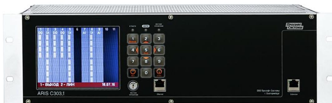
Рисунок 3 – Общий вид контроллеров исполнения ARIS C303.1 (вид спереди)
