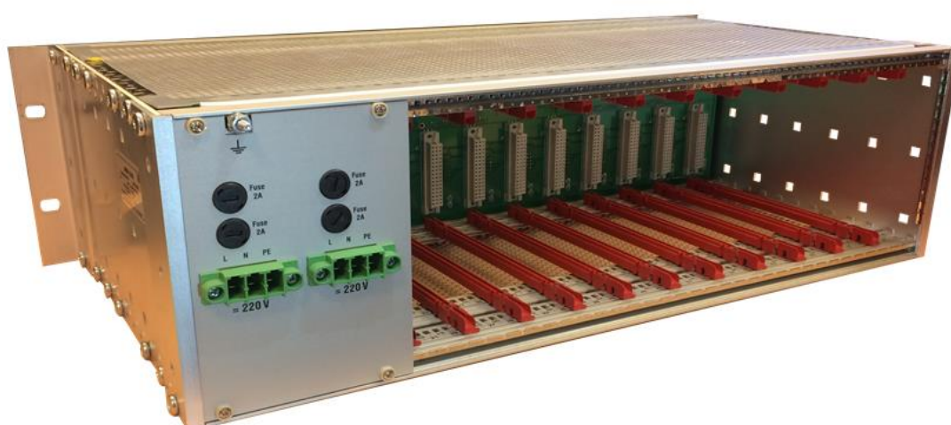
Рисунок 6 – Общий вид контроллеров исполнения ARIS C303.2 (вид сзади, модули не установлены)
