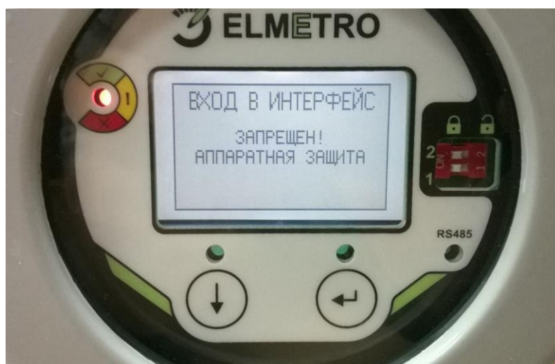
Рисунок 3 – Место пломбирования расходомера и сообщение на дисплее при запрещающем положении микропереключателей
